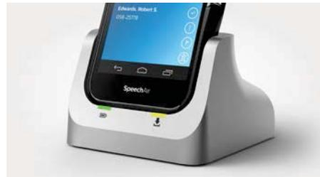
Auch mit der Schutz-Hülle passt das SpeechAir Diktiergerät perfekt in die Dockingstation, um automatisch alle Aufnahmen zu übertragen und das Gerät schnell aufzuladen.
